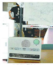
各世帯に配られている防災無線の受信機
