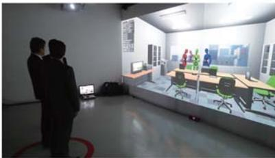
実験室内の映像体験に、人感センサーにより人型モデルを表示する機能を追加した。人型モデルは人間の動きに連動し、家具と接触すると赤くなる等、地震体感がよりリアルなものとなる。
