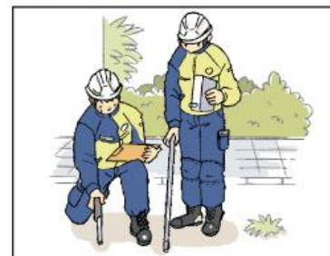
路上漏えい調査
