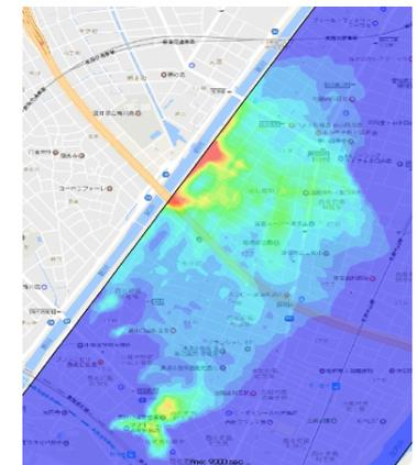
建物占有率の入力条件による氾濫解析の比較：東海豪雨時の新川破堤2.5時間後の流速分布 (左：街区構造モデル、右：格子ごとに付与)
