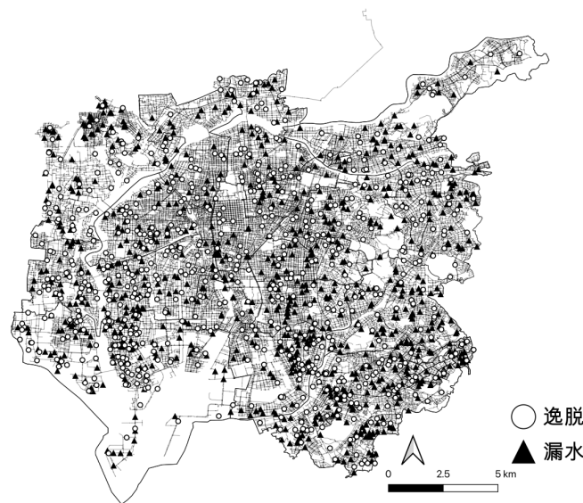
図1 南海トラフ地震への離散的管路被害推定モデルの適用結果(名古屋市)
