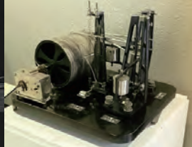
「国立科学博物館と岐阜県立博物館にだけ残る今村式2倍強震計の実物（岐阜県立博物館で武村撮影、2022）」
