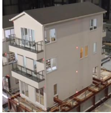
図1 木造住宅試験体と数値解析モデル
