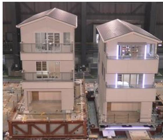
桝組壁工法 軸組工法 図1 2019年E-Defense振動台実験
