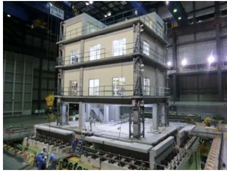
(1)免震試験体 (平成25年3月実験) E-Defense長周期化改造工事 における振動台性能確認試験 佐藤ほか(2013)
