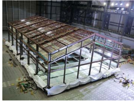
(2)体育館試験体 平成26年1月実験 大規模空間を有する試験体の地震時拳動天井の 脱落被害メカニズムの解明を目的とした実験 梶原ほか(2014)
